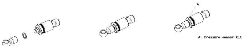
Figure 3 - Kit du capteur de pression assemblé
