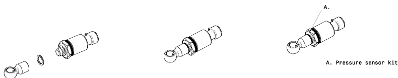
Фигура 3 - Сглобен kit на датчик за налягане
