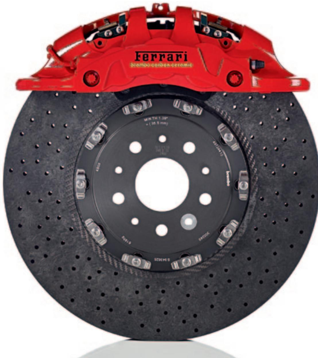
Auto. Impianto frenante anteriore con disco in carbonio ceramico e pinza Extrema, destinato a supercar Ferrari.
