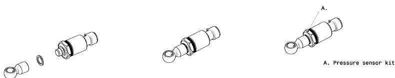
Joonis 3. Monteeritud rõhuanduri komplekt
