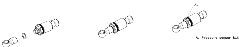
Kuva 3- Paineanturin kit-sarja koottuna
